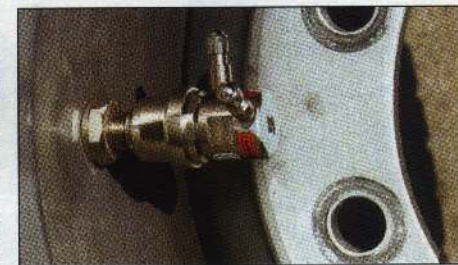
Шинам Supersingle необходим специальный вентиль с двумя подводами для шины и внутреннего кольца, а также защитная крышка для дискового тормоза
